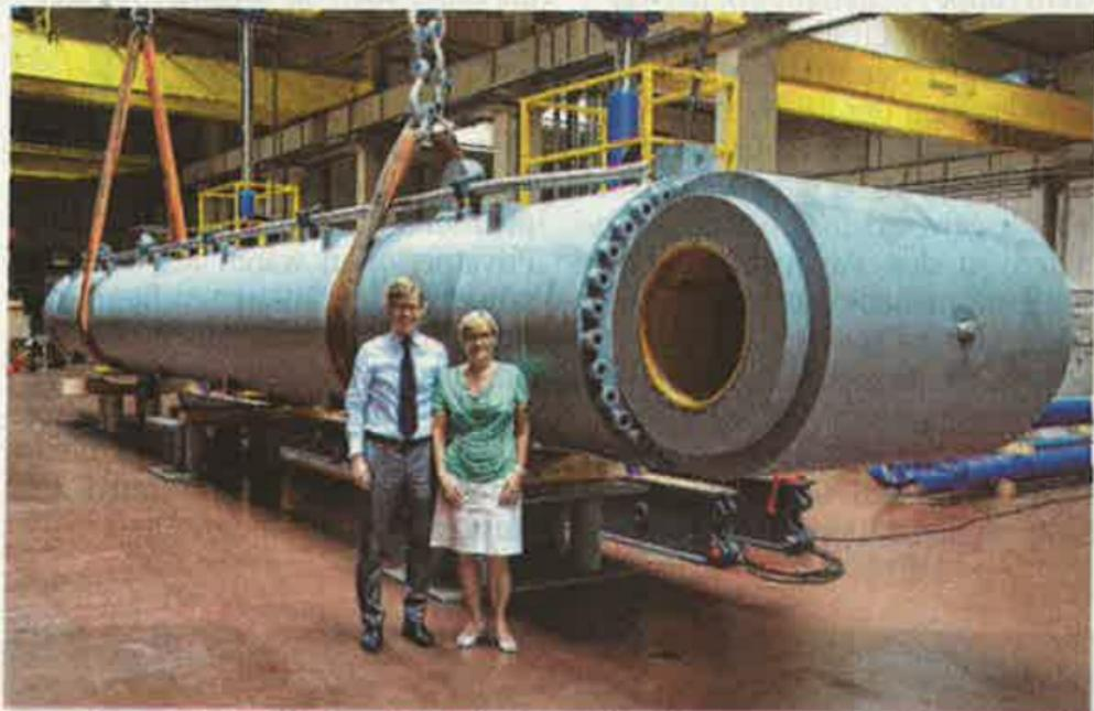
**LOHR (amk)** In der vergangenen Woche wurde ein weiterer Großzylinder bei der Firma Hunger Hydraulik GmbH & Co KG in Lohr fertiggestellt und von der chinesischen Prüfbehörde CCS erfolgreich abgenommen. Der Hydraulikzylinder soll auf einer schwimmenden Plattform für eine Pfahlramme im chinesischen Tsingtao verwendet werden, mit deren Hilfe bis zu 110 Meter lange Stahl-Betonpfeiler in den Meeresgrund gerammt werden. Auf hunderten dieser Pfeiler werden
